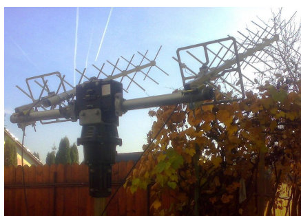
Antene UHF care urmăresc automat un satelit LEO
