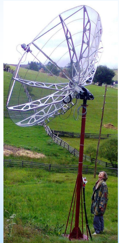
Parabola motorizata de 3 m diametru poate urmari automat un nanosatelit aflat pe orbita terestra joasa. Domeniu de frecvente 1-6 GHz.
