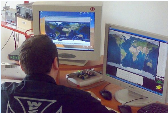
Sistemul de comanda si comunicatii sol-satelit. Pozitia satelitelului si efectul Doppler sunt calculate automat pe baza elementelor orbitale furnizate de Comandamentul Spatial al USA.
