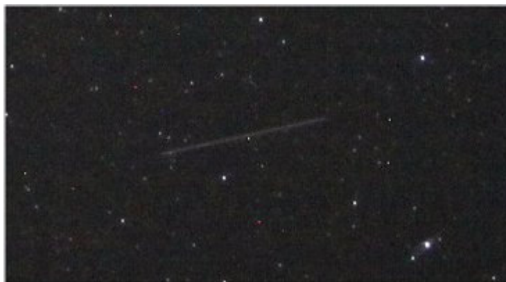
Treapta de racheta Cosmos 1892. Stelele din fundal permit determinarea azimutului si elevatiei obiectului iar cataloagele TLE permit identificarea sa (daca obiectul este catalogat). Lucrul in tandem cu un al doilea instrument LEOSCOP permite si determinarea altitudinii obiectului, prin triangulatie.
