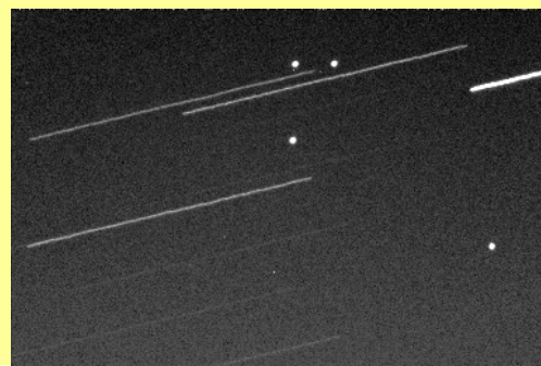
Experiment de detectare optica a satelitilor geostationari, la Observatorul Astronomic Feleacu (stinga) si fotografie cu sateliti GEO (dreapta). Punctele sunt sateliti iar liniile stele. Actiune pregatitoare pentru URSA (sfirsitul lui 2006).
